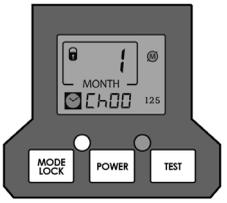
증상 : LCD 문자불량, (Segment 불량), LCD 부분 변색
