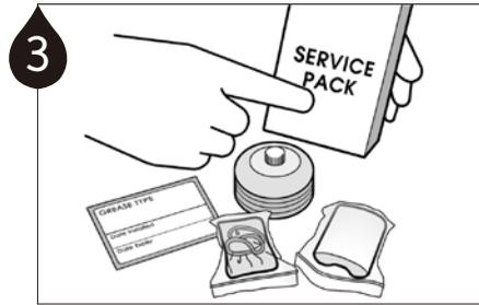
3 서비스 팩의 파우치 용량을 확인하고 구성품 (배터리 팩, 파우치, 더스트 커버, 메모리벨)을 확인합니다.
