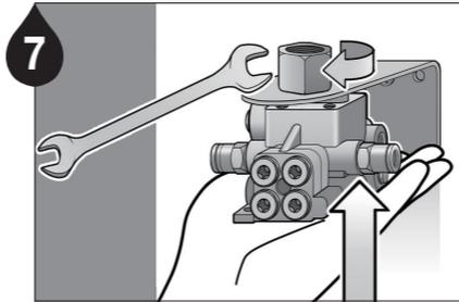
주유기 본체를 설치된 브라켓에 시계방향으로 17mm 스패너를 이용하여 설치합니다.
