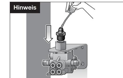
8 Füllen Sie den Verteilerblock mit einer Fettpresse und einem 3/8" Schmiernippel mit demselben oder einem kompatiblen Fett vor.
