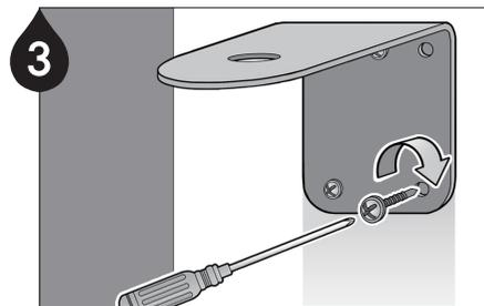
4 Installieren Sie die Montagehalterung (B002) an einer geeigneten Position mit den Schrauben (B051).
