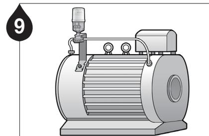
11 Installieren Sie für Motorlageranwendungen die Montagehalterung an einer geeigneten Stelle mit dem 2-Punkt-Ferninstallationsatz und verbinden Sie dann beide Lager mit Schmierleitungen.
