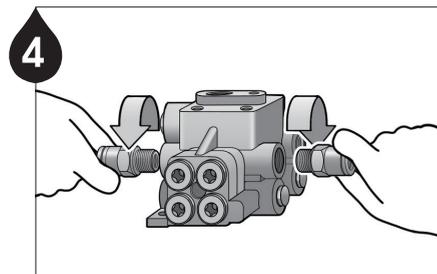
5 Schrauben Sie die Steckverbinder an jedem Ausgang des Progressivverteilers.
