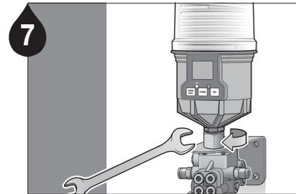
9 Installieren Sie den Schmierstoffgeber mit einem 17-mm-Schlüssel an der Halterung.
