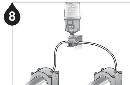
10 Für typische Lageranwendungen installieren Sie den Progressivverteiler mit Kupfer- oder Nylonleitungen am Gerät.
