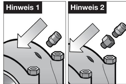
**Hinweis 1** Installieren Sie direkt auf der Schmierstelle eine A240 Push-Fit Rohrverschraubung, **Hinweis 2** Verwenden Sie gegebenenfalls geeignete Adapter.
