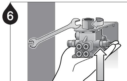
7 Verbinden Sie den Progressivverteiler am Adapter, der Unterlegscheibe und der Montagehalterung und drehen Sie den Adapter (A002) zum Festziehen im Uhrzeigersinn.
