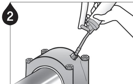
2 Stellen Sie mit einer Fettpresse einen freien Durchgang sicher. **Hinweis 1** Entfernen Sie ausgehärtetes Fett, indem Sie die Schmierstelle mit einer manuellen Fettpresse spülen. **Hinweis 2** Das Fett im Gerät und das im Gerät enthaltene Fett sollten gleich oder kompatibel sein.
