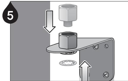
6 Installieren Sie den Adapter (A002) an der montierten Montagehalterung mit der Unterlegscheibe (B058) an der Unterseite.
