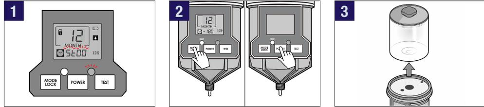
LCD에 점검표시 및 배터리팩 아이콘이 표시되면 배터리 팩을 교체해주세요.
