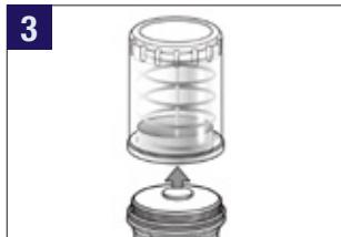
Entfernen Sie das Gehäuse vom Hauptgerät.
