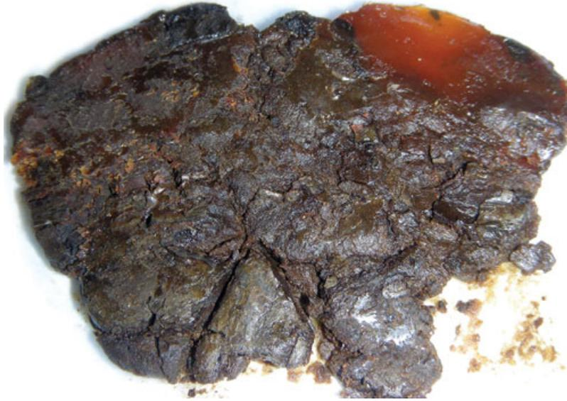
그림 1: 이 그리스 이미지는 그리스 내부의 오일이 구리로 인해 조기 산화됨으로써 심각하게 단단하여 지는 것을 보여준다. 그리스 내의 구리 촉매 금속의 농도가 올라간 것은 마모 찌꺼기 때문이다.
